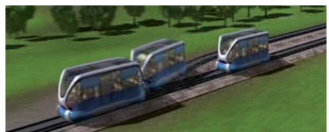
VR-Simulation der Konvoibildung des Paderborner RailCabs
