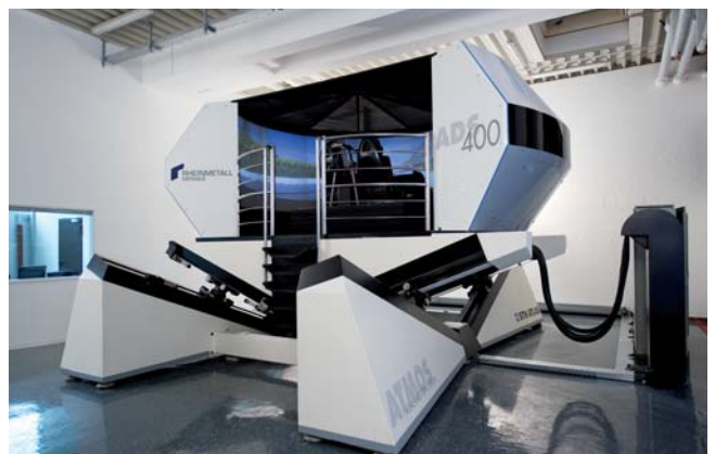
Fahrsimulator für die Analyse von Fahrzeugsystemen und -komponenten am Zentrum für Fahrsimulation des Heinz Nixdorf Institut
