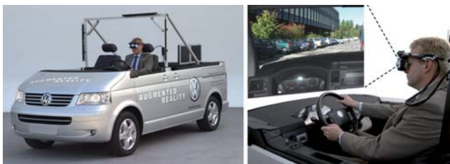
Fahrzeuginnenraumvisualisierung mit der AR-Versuchsplattform
