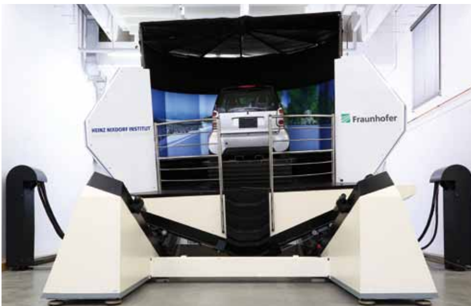
Der interaktive Fahrsimulator des Heinz Nixdorf Instituts
