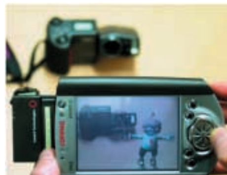
Prototyp des AR-PDA: Ein virtueller Charakter erläutert die Funktionsweise der auf dem Tisch liegenden digitalen Kamera
