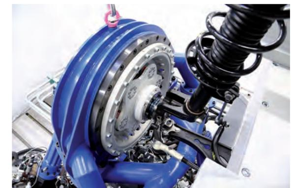
Hydraulischer Hexapod zum Testen mechatronischer Fahrzeugachsen
